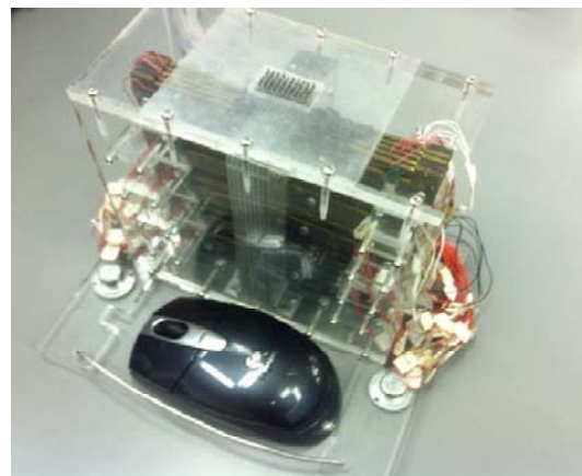
図 2. 振動ピン配列型触覚ディスプレイ (TD2R)
