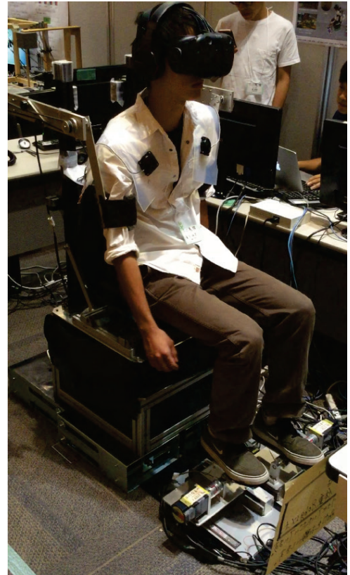
図 6 身体的刺激提示（前庭感覚，上肢下肢運動感覚，振動触覚，気流触覚，嗅覚への提示）と全天球映像，立体音響提示
